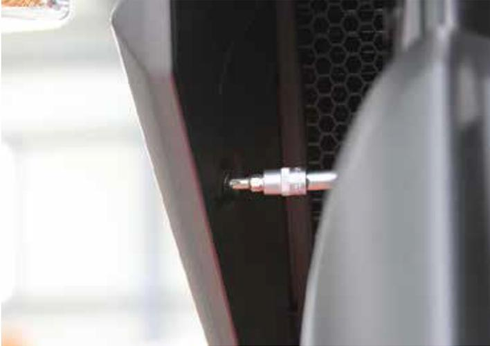
4. Usando una llave Allen de 5 mm, retire los pernos superiores. De nuevo, de ambos lados, derecho e izquierdo.
