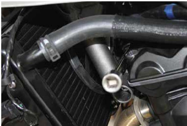
12. Monte el protector del motor en el lado derecho. Asegúrese de usar líquido de bloqueo de roscas (azul) y deje los tres pernos sueltos.
