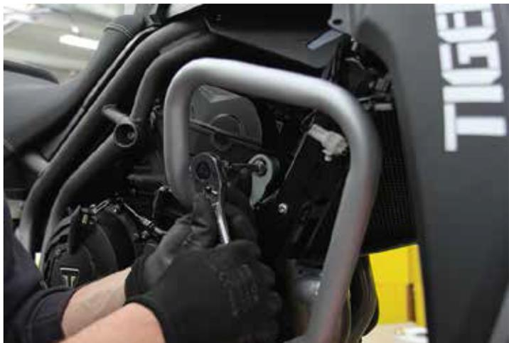
14. Inserte los dos pernos Allen M8 a través de la pestaña de montaje inferior de la barra de protección, conectándola así con el protector del motor. Coloque una arandela en cada uno de los dos pernos y enrosque las tuercas nyloc. Apriétalas suavemente.
