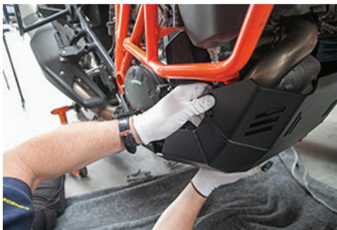
14. Inserte los pernos Allen de 8 mm de diámetro a través del montaje superior del lado derecho. Enrosque las tuercas nyloc suministradas en el extremo. Déjelas sueltas.
