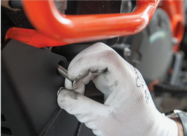
16. Inserte los pernos Allen de 8 mm de diámetro a través del montaje trasero del lado izquierdo. Enrosque las tuercas nyloc suministradas en el extremo. Déjelas sueltas.
