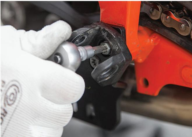
6. Retire el perno de montaje de la parte izquierda del motor/barra protección.
