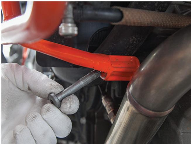
12. Monte el soporte del protector de cárter delantero del lado derecho (pieza corta). Vuelva a colocar el perno de montaje del motor de fábrica. Déjelo suelto por ahora.
