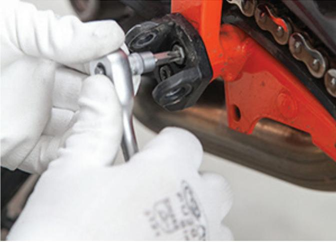
4. Monte el soporte de montaje del protector de cárter trasero del lado izquierdo.
