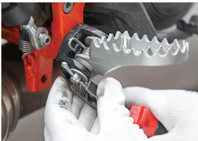
10. Monte el soporte de montaje del protector de cárter trasero del lado derecho.
