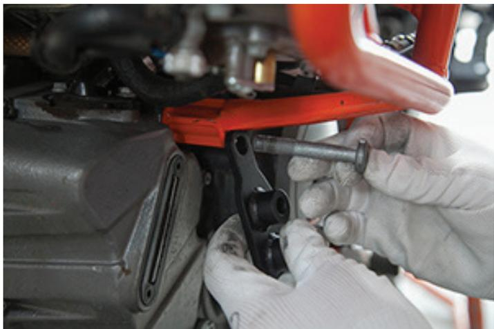
8. Retire el perno Torx de la parte inferior del cilindro principal del freno trasero. **¡Asegúrese de volver a colocar este perno después del paso 17!**
