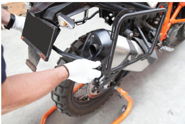
12. Usando los cuatro pernos hexagonales M6x20mm, las tuercas de bloqueo y las arandelas, asegure el refuerzo transversal trasero. Herramientas recomendadas: llave inglesa de 10 mm y un zócalo y trinquete de 10 mm, pero otra opción son dos llaves inglesas de 10 mm. ¡Finalmente apriete TODOS los pernos y tuercas!
