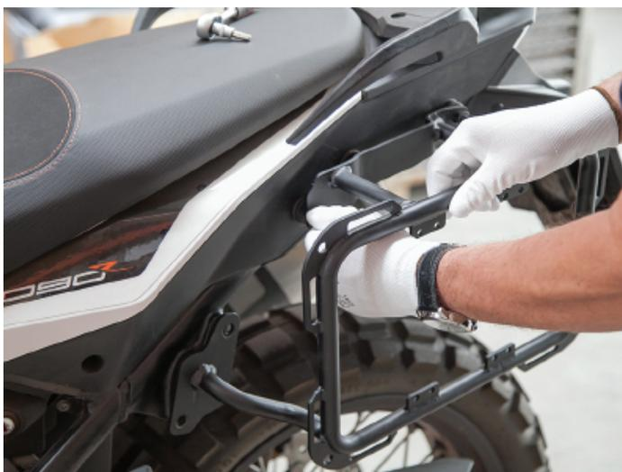
4. Asegúrese de que el portaequipajes esté lo suficientemente suelto como para que quepan los espaciadores detrás de la pestaña de montaje.
