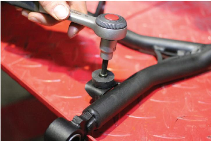
2. La lubricación de los orificios de montaje del soporte central con grasa mecánica mejorará la funcionalidad.
