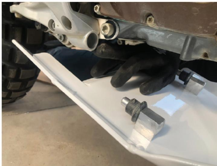
10. Enrosque a mano los pernos M6 hexagonales / torx suministrados tras alinear los orificios de montaje en el protector de cártter y el soporte montado en el marco. Apriete los pernos con un zócalo de 10 mm , una llave inglesa o una llave torx.
