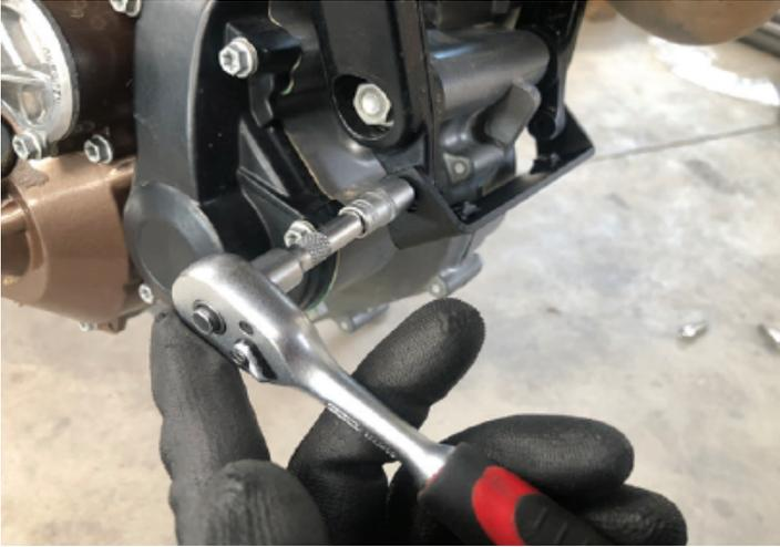
4. Asegúrese de que el soporte está lo suficientemente suelto para alinear los orificios de montaje del soporte y el protector de cátodo.
