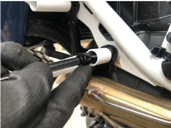
6. Retire el perno Allen inferior de fábrica del lado derecho de la motocicleta.
