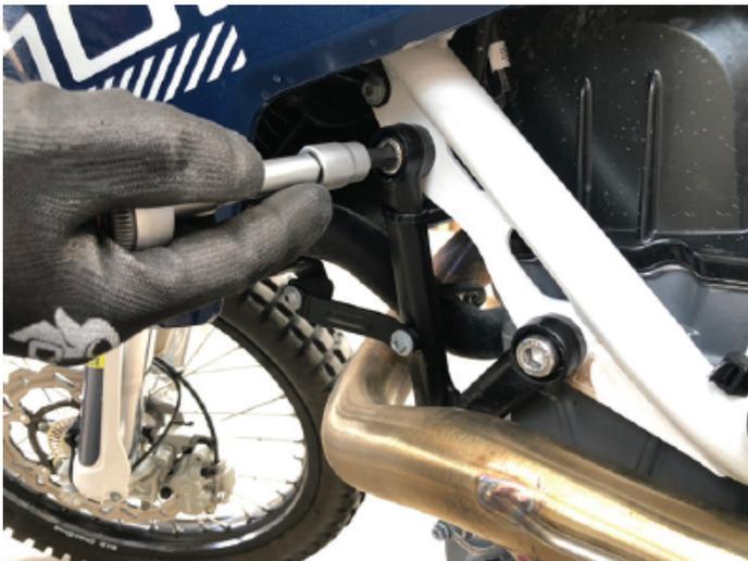
2. Retire el perno Allen inferior de fábrica del lado izquierdo de la motocicleta.
