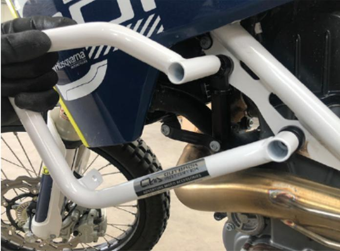
4. Inserte el perno M10x30mm suministrado en la parte superior. Sólo una o dos vueltas para mantener el perno suelto.
