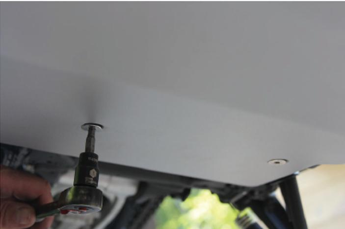
6. Apriete ahora el perno del soporte de montaje del protector de cárter con un zócalo de 12 mm y un trinquete. Especificaciones del par de torsión recomendadas por la fábrica 44Nm.
