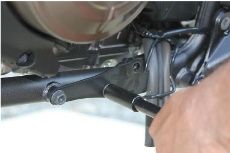
2. Tome la cruceta del soporte del protector de cárter suministrada y colóquela en la estructura debajo del motor.
