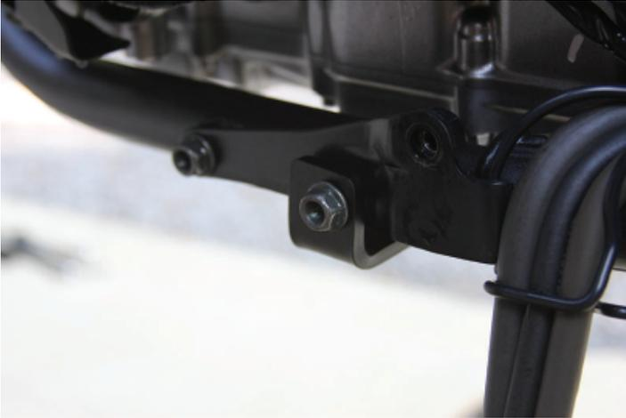
4. Monte el protector de cárter. Primero inserte los dos pernos Allen M8 de cabeza redonda con las arandelas, enrósquelos y apriételes suavemente con una llave Allen de 5 mm o con un zócalo Allen de 5 mm. Déjelos sueltos.
