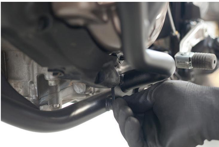
6. Vaya al lado derecho (lado de escape) de su Africa Twin. Mire debajo de la motocicleta. Hay dos pernos pasantes en la estructura. Con dos llaves inglesas de 14 mm, afloje y retire solo las dos tuercas del lado opuesto de la estructura. Los pernos pasantes NO deben ser retirados.
