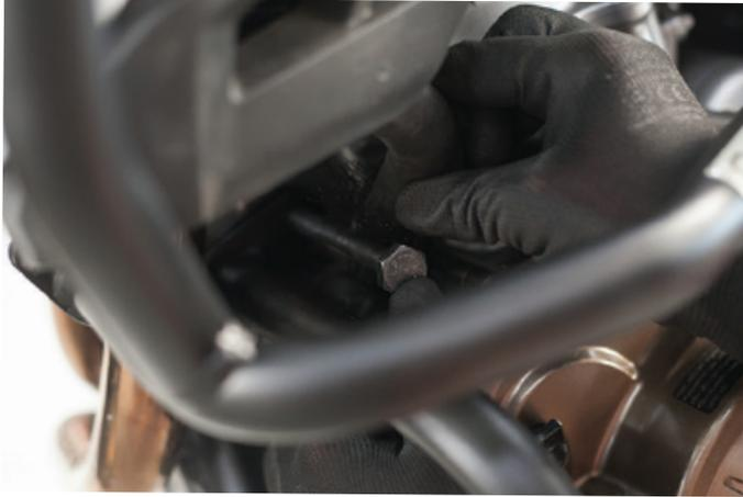
4. Monte la contraparte de la abrazadera en la barra de refuerzo. Inserte los dos pernos Allen de cabeza redonda suministrados. Coloque las arandelas y enrosque a mano las tuercas nyloc.
