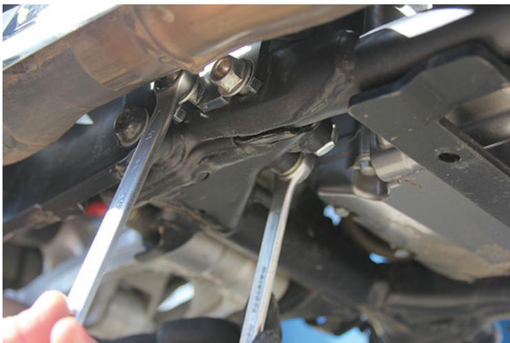
10. Monte la protección del motor del lado derecho. *Consejo: es más fácil si los pernos pasantes no se pasan completamente. Deje que se muestre una rosca de aproximadamente 10 mm/1/2", luego asegúrese de que la abrazadera esté colocada justo en la pestaña superior de la barra de protección.*
